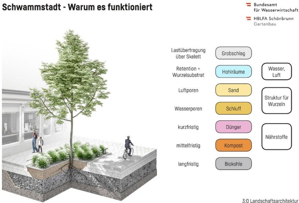
Abb. 7 Aufbau und Funktion der Schwammstadt-Komponenten im Unterbau
